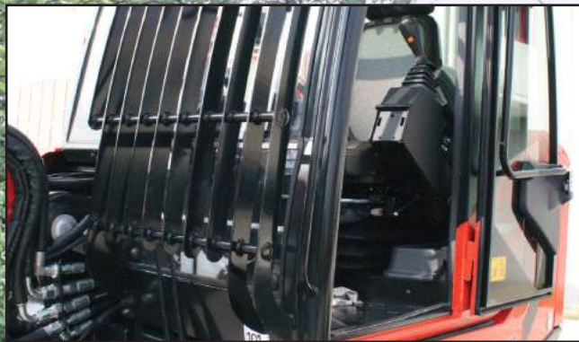
Griglia di protezione per cabine Protection of the cabin Grille de protection cabine Schutzgitter der Kabine
